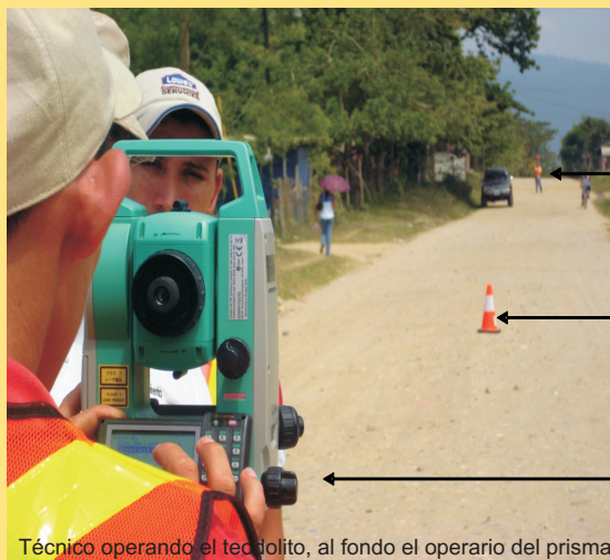
Técnico operando el teodolito, al fondo el operario del prisma
